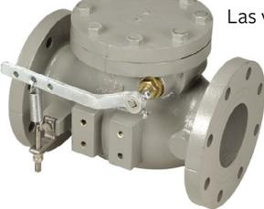
Las válvulas se ajustan a todas las exigencias descritas en la última edición de la norma AWWA C508. Se destacan sus usos en el agua residual, agua potable, aguas negras, petróleo y gas. Las series 8001 se producen con un cuerpo de hierro fundido, anillos de asiento de bronce o acero inoxidable, recubrimientos de disco
