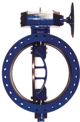
La válvula de mariposa Triton™ de Pratt presenta un asiento de caucho en el cuerpo, que reduce los problemas de rendimiento relacionados a acumulaciones corrosivas en el cuerpo de la válvula y en las tuberías. El asiento E-Lok se puede ajustar y/o reparar en campo sin desaguar la tubería ni quitar la válvula de la línea. El disco presenta un diseño con flujo directo, que permite una fuerza mayor, un peso menor y un área de flujo libre mayor. Un Cv más alto: una menor pérdida de presión da
