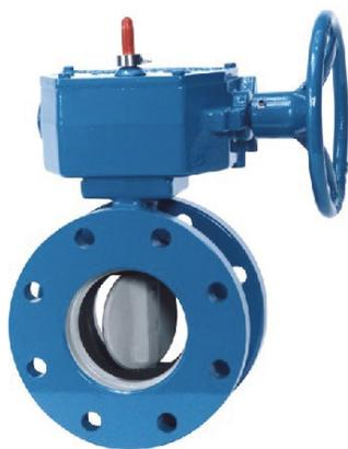
Las válvulas de mariposa con asiento de caucho 2FII™ de Pratt están disponibles en los tamaños de 3" a 20". Los vástagos se construyen con barras de acero inoxidable ASTM A276 tipo 304 o 316 rectificadas sin centros y, por lo tanto, no son vulnerables a la corrosión, a diferencia del acero al carbono u otros materiales similares. Los vástagos se construyen en una sola pieza, tienen un diseño de vástago pasante y cumplen o
